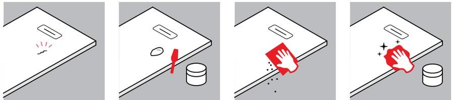
Novellini assure la garantie du produit après la découpe uniquement si la surface découpée de celui-ci a été traitée avec le Kit de réparation pour une étanchéité totale.
