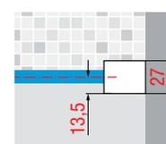
Détail du système de fixation au receveur de douche
