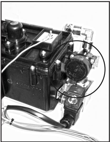
**IT** Filtro acqua caldaia - Pulire periodicamente
